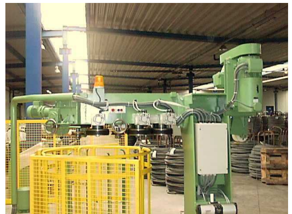
Biegewickler Spiralverlegeinrichtung zur Erzielung kompakter Bunde
