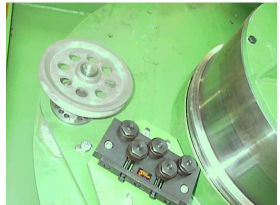
Wickelrotor mit Richtvorrichtung und Wickelscheibe mit Richtrand
