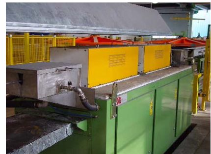
Induktionsofen mit Abschreckbad
