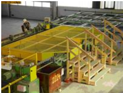
Ringschere, Doppelringaufsammler, Schlingenbett
