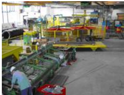
Stabschere mit Bündelbank
