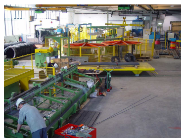
Ножницы для резки прутков с увязочной машиной
