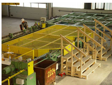
Ножницы для колец проволоки, двойной укладчик, петлевой колодец
