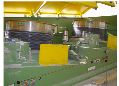
Волочильный стан с барабанами \varnothing 1200 мм
