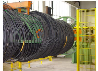
Разматыватель с виткоукладчиком
