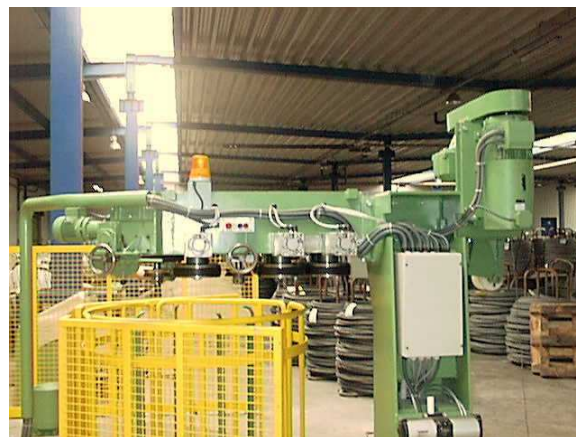
Моталка с приспособлением для спиральной укладки проволоки в компактные бунты
