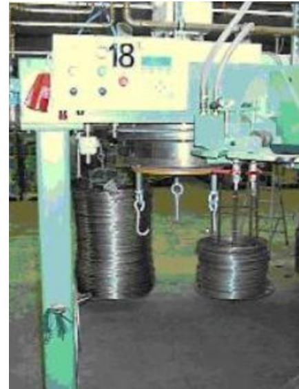
Wickelscheibe, Kombination von V-Scheibe und zylindrischer Scheibe
