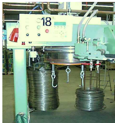
Барабан моталки, комбинация барабана с V-канавкой и цилиндрического барабана
