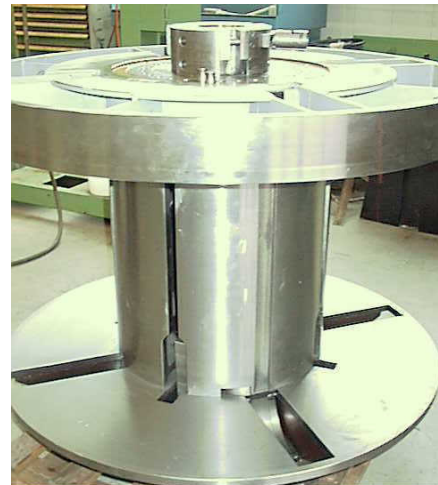
Teilbare Spule mit Innengreifer für Lage-Lage gespulte Coils
