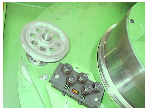
Ротор моталки с устройством для правки и Барабан моталки с правильным краем
